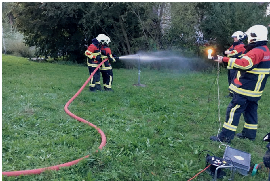
Versuchsaufbau 1: Demonstration der Leitfähigkeit von Strom durch einen Wasserstrahl
