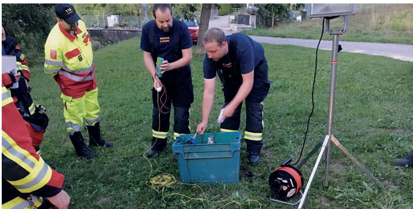
Versuchsaufbau 2: Simulation eines unter Wasser stehenden Kellers in den eine metallische Wasserpumpe getaucht wird
