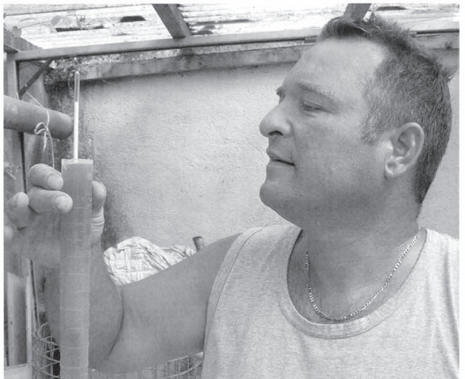
1049 - die Stammwürze wird mit der Spindel bestimmt
